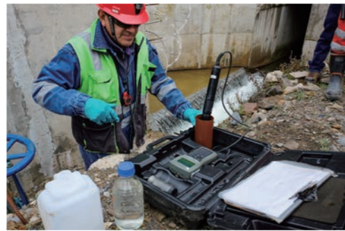
鉱さい集積場からの河川放流水の水質チェックを行なっています。(ワンサラ鉱山)
