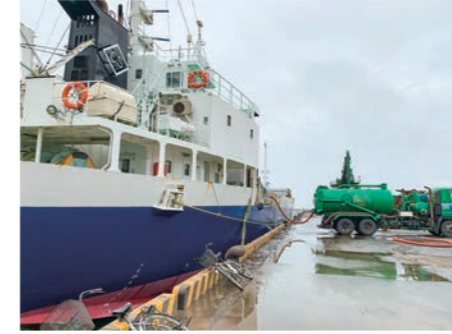
【右】 垂鉛精鉱輸送船から鉱石を降ろした後の洗浄用水も回収しています(八戸製錬)。
