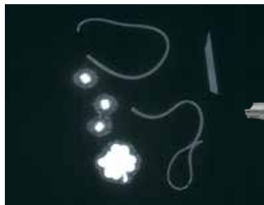
食品中に混入したプラスチック(近赤外線発光する色素を含む)の検出イメージ
