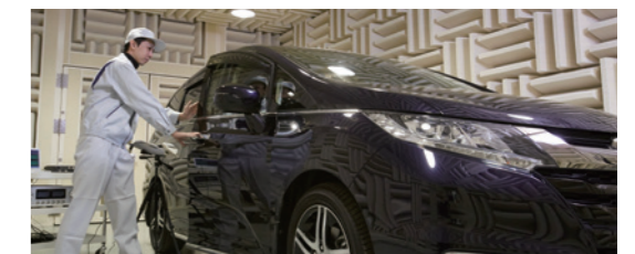
高級感のあるドア閉まり音を作り込む様子
