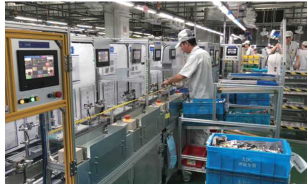
自動車用ドアラッチの生産ライン
