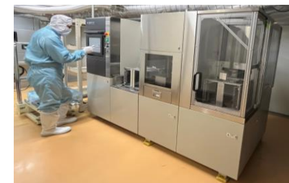
HRDP®専用自動剥離装置 (DOE設備の一部)
