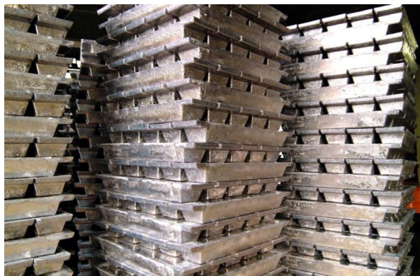
■ リサイクル製錬で回収された鉛地金
